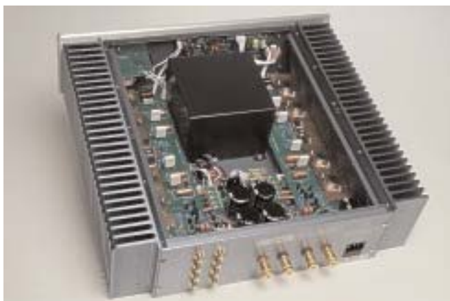
Κλασική αρχιτεκτονική του ολοκληρωμένου με το τροφοδοτικό στην μέση και τα στάδια ισχύος τοποθετημένα πλευρικά. Οι ψύκτρες είναι εξωτερικές.
