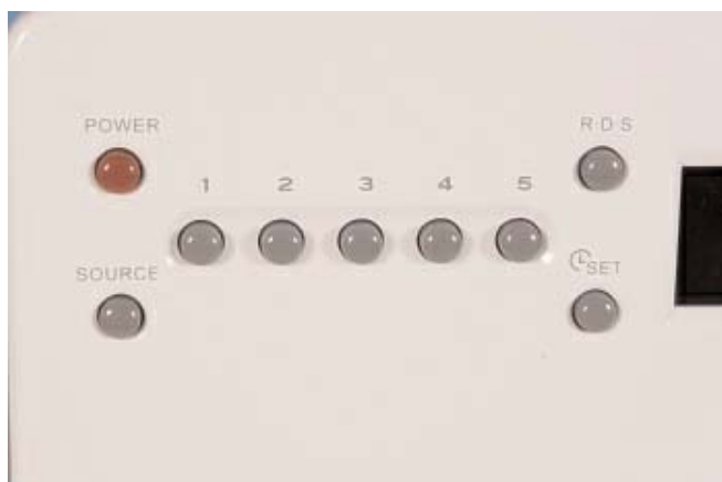
Απλοί, εύχρηστοι διακόπτες για τον επιλογή εισόδου, τις μνήμες του δέκτη, την ενεργοποίηση του RDS και τον έλεγχο του χρονοδιακόπτη αφύπνισης.
