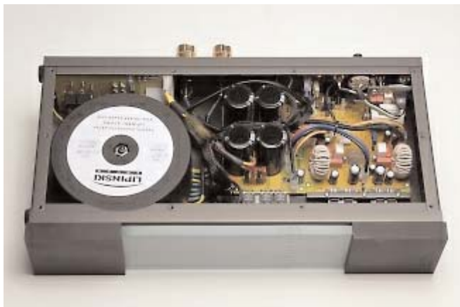
Ο μονομπλόκ L-301 είναι διακοπτικός και αποδίδει 300W σε κανονική λειτουργία και 600W γεφυρωμένος.
