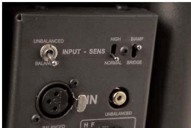
Balanced και single ended είσοδος, με τον αντίστοιχο επιλογέα και δυνατότητα ρύθμισης της ευαισθησίας
