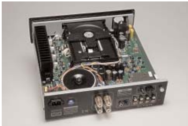
Το εσωτερικό κρύβει μια καλή κατασκευή με προσοχή σε κρίσιμα σημεία. Όλα τα κυκλώματα βρίσκονται τοποθετημένα σε μια πλακέτα.
