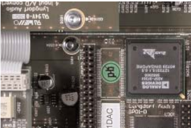
Η καρδιά του προενισχυτή είναι ο επεξεργαστής της οικογένειας Blackfin της Analog Devices. Ακριβώς από κάτω βρίσκεται η μνήμη flash που τον υποστηρίζει.
