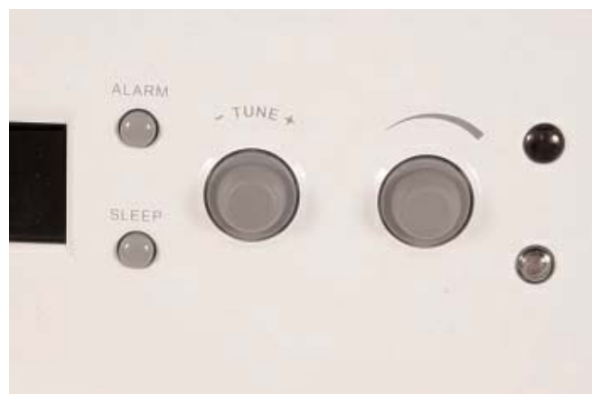
Δύο περιστρεφόμενα ρυθμιστικά, για τον συντονισμό και την στάθμη. Η συσκευή έχει δύο αισθητήρες, έναν για τον τηλεχειρισμό (επάνω δεξιά) κι έναν για την αυτόματη ρύθμιση της φωτεινότητας της οθόνης (κάτω δεξιά).
