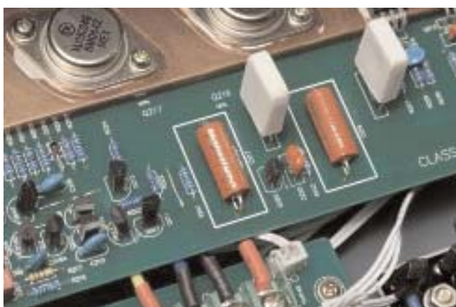
Ο ενισχυτής χρησιμοποιεί διακριτά εξαρτήματα και custom πυκνωτές πολυπροπυλενίου της Xindak.
