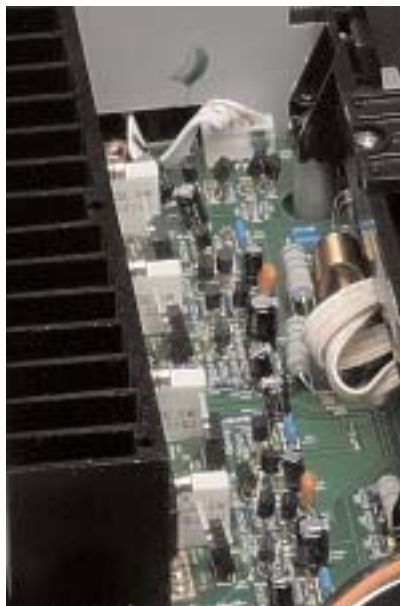
... ενώ ο τελικός ενισχυτής χρησιμοποιεί διπολικούς ημιαγωγούς της Sanken και διακριτά εξαρτήματα παντού.
