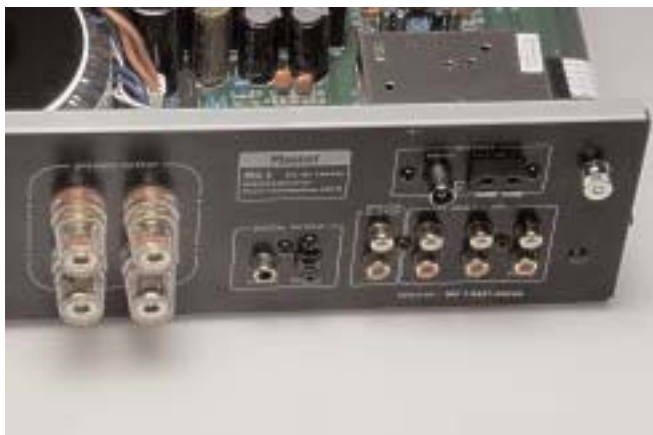
Το MC-1 είναι πλήρες από πλευράς εισόδων. Υπάρχουν τρεις εισόδοι line, ένα tape loop και είσοδος phono, ενώ δεν λείπουν και οι ψηφιακές εξόδοι για εγγραφές.
