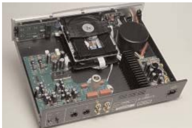
Στο εσωτερικό του cd player δεσπόζει ένα σχετικά μεγάλος μετασχηματιστής (δεξιά). Κάτω αριστερά είναι τα κυκλώματα των αναλογικών εξόδων.
