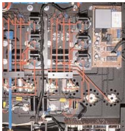
Το εσωτερικό του ενισχυτή είναι πραγματικό κέντημα. Η κατασκευή, με ελάχιστες εξαιρέσεις είναι αράχνη και η πειθαρχία των καλωδίσεων παραδειγματική.
