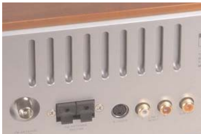
Το ITR 10 είναι πλήρες όσον αφορά στις δυνατότητες σύνδεσης: Υπάρχουν δύο line in (η μια στην πρόσοψη), έξοδος για οδήγηση υπογούφερ και έξοδος σήματος εικόνας για το iPod Video.
