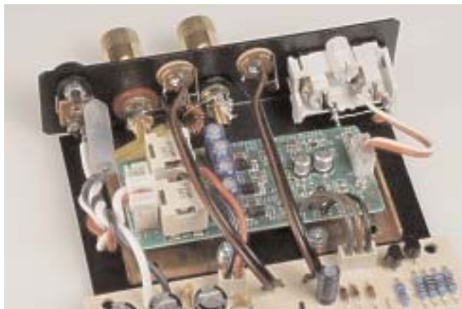
Ο τελικός ενισχυτής χρησιμοποιεί ένα διακοπτικό στάδιο του οποίου την προέλευση δεν μπορέσαμε να αναγνωρίσουμε. Κάνει πάντως πολύ καλή δουλειά, χωρίς θόρυβο.
