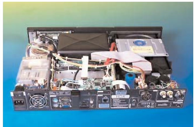
Το εσωτερικό του HDX είναι εξαιρετικά σύνθετο. Παρόλα αυτά, η Naim έχει διατηρήσει μια πολύ καλή ποιότητα κατασκευής και έχει υιοθετήσει μια αρχιτεκτονική πλήρους απομόνωσης μεταξύ υπολογιστή και DAC.
