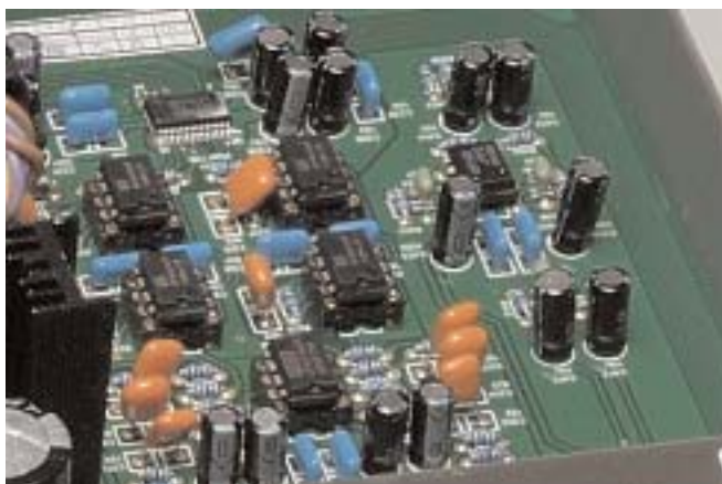
Το στάδιο εξόδου του CD/SACD player με τον DAC της Burr Brown (επάνω) και τους πέντε τελεστικούς ενισχυτές σε ρόλο μετατροπέα i/v και φίλτρου εξόδου.
