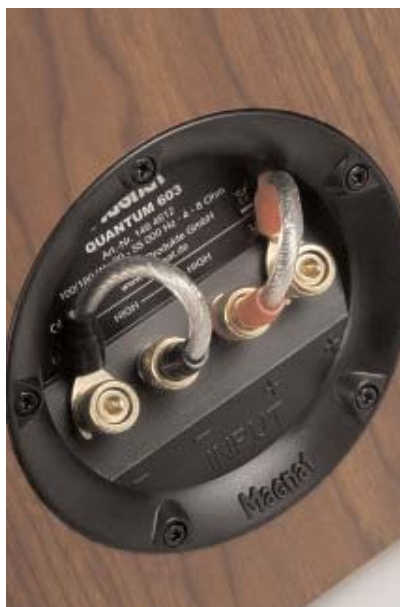
“Χούφτα” με διπλοκαλωδίωση στην οποία περιλαμβάνονται δύο πολύ καλής ποιότητας γέφυρες... Η Magnat θέλει να είναι σίγουρη...
