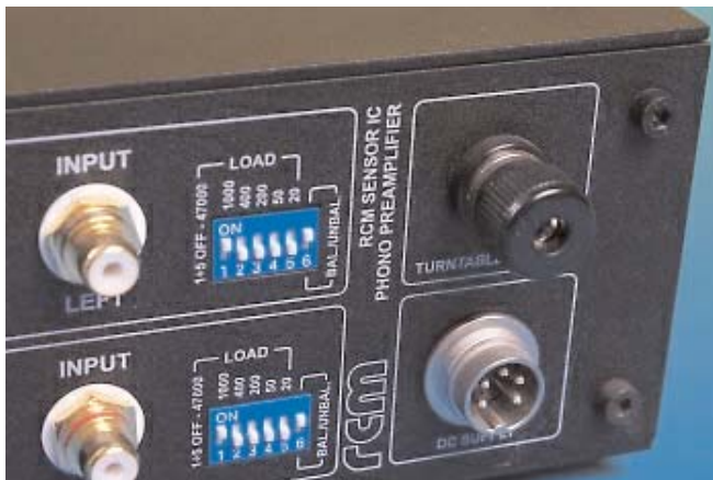
Εδώ φαίνεται η βύσμα σύνδεσης του μετασχηματιστή τροφοδοσίας (κάτω δεξιά) και της γείωσης του πλατό (επάνω δεξιά).
