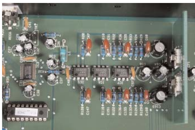
Τρεις τελεστικοί ενισχυτές έχουν αναλάβει το έργο του i/v conversion και του φίλτρου διέλευσης χαμηλών.
