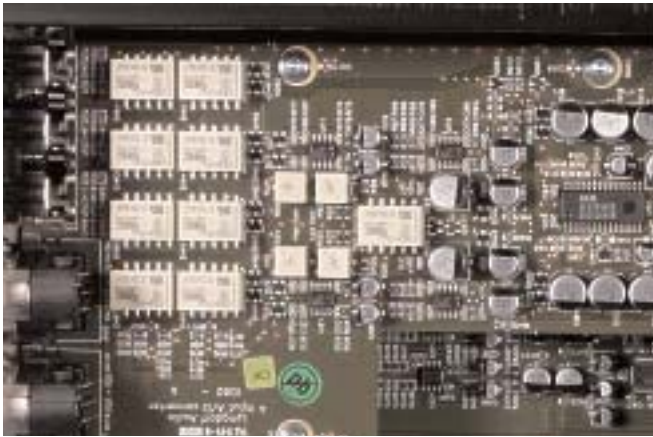
Ο μετατροπέας A/D βασίζεται στον πολύ γνωστό Millennium της εταιρίας και προσφέρει ανάλυση 192kHz/24bit.
