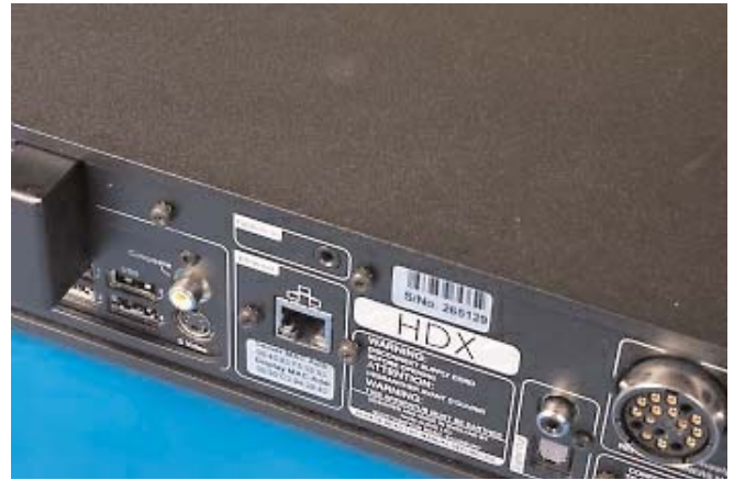
Το Ethernet είναι απαραίτητο για να επικοινωνεί η συσκευή, μέσω του router, με τις online βάσεις δεδομένων από όπου αντλεί metadata για τα CDs.
