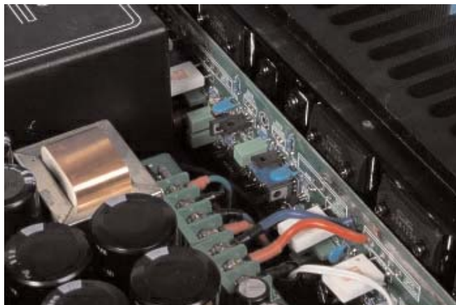
Ο τελικός ενισχυτής χρησιμοποιεί συμπληρωματικά ζεύγη τρανζίστορς της Sanken τα οποία έχουν δυνατότητα ελέγχου ρεύματος 17A. Το κύκλωμα που προηγείται είναι με διακριτά εξαρτήματα.
