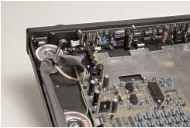
Το κύκλωμα του Τιμπαρο είναι αρκετά σύνθετο περιλαμβάνοντας ενισχυτικά στάδια σε τάξη Α με διακριτά κυκλώματα και ψηφιακά ελεγχόμενο ρυθμιστικό στάθμης.
