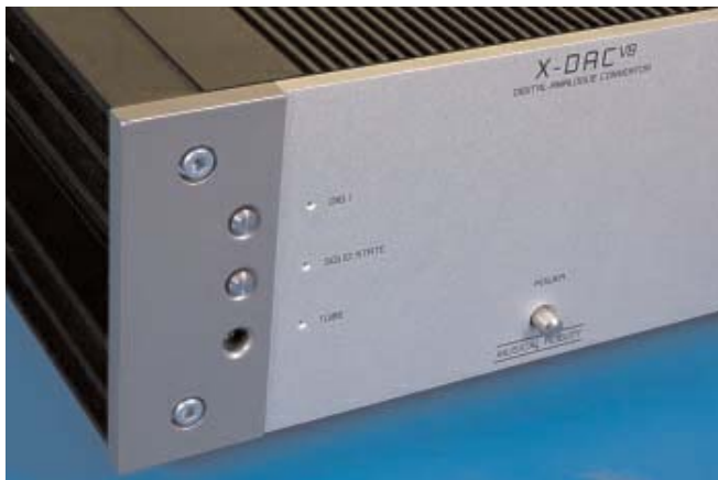
Στην πρόσοψη υπάρχει ο διακόπτης που επιτρέπει την επιλογή μεταξύ του "σκέτου" ημιαγωγικού σταδίου εξόδου και του απομονωτή με τις λυχνίες.
