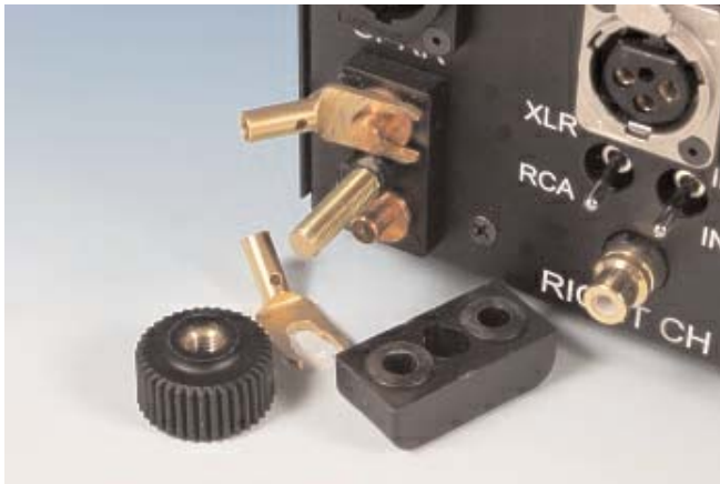
Για την σύνδεση των ηχείων χρησιμοποιείται το χαρακτηριστικό "διπλό" βύσμα της Cardas το οποίο συσφίγγει και τους δύο ακροδέκτες ταυτόχρονα χωρίς μεγάλη προσπάθεια και χωρίς εργαλεία.
