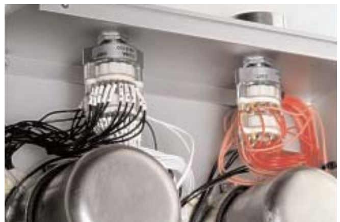
Αριστερά φαίνεται ο επιλογέας των μεσαίων λήψεων, ο οποίος καθορίζει το κέρδος του προενισχυτή, ενώ δεξιά είναι ο επιλογέας εισόδων.
