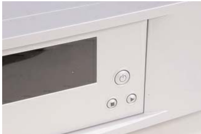
Στην πρόσοψη της συσκευής υπάρχουν πλήκτρα για τους στοιχειώδεις χειρισμούς. (play, stop, next, κ.λπ). Ο χρήστης μπορεί να επιλέξει το τί θα απεικονίζεται στην οθόνη. Στις πληροφορίες περιλαμβάνονται χρόνοι, στοιχεία του encoding και metadata.
