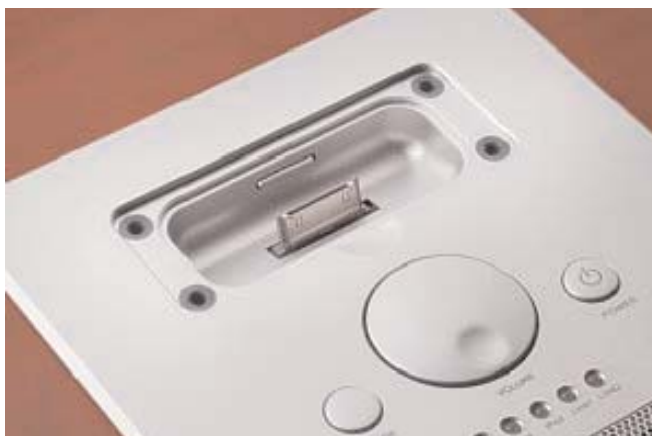
Στην επάνω επιφάνεια υπάρχει το docking station για τα iPod, το βηματικό ρυθμιστικό στάθμης, ο επιλογέας εισόδων και το On-Off.
