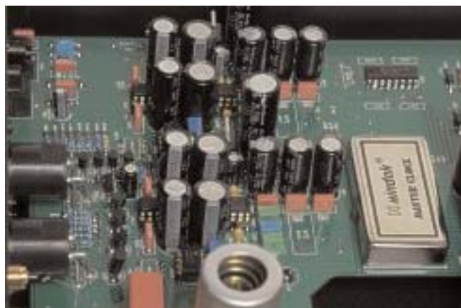
Το αναλογικό στάδιο του cd player περιλαμβάνει ολοκληρωμένα της Burr Brown. Το κύκλωμα που παράγει το clock της συσκευής βρίσκεται κάτω από τη θωράκιση, δεξιά.
