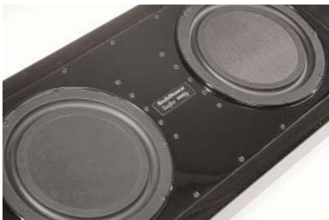
Το SubRosa χρησιμοποιεί κλειστή καμπίνα με πολύ μικρό όγκο, αν αναλογιστεί κανείς τα δύο δεκάντα γούφερ. Μπορεί να τοποθετηθεί κάθετα ή παράλληλα προς το δάπεδο. Οι βίδες ανάμεσα στις δύο μονάδες χρησιμοποιούνται για την στήριξη της δοκού I-Beam η οποία καταστέλλει τους κραδασμούς της καμπίνας.
