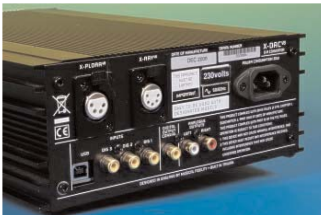
Προσφέρονται τρεις κλασικές ομοαξονικές ψηφιακές εισόδους καθώς επίσης και εισόδους USB για την σύνδεση υπολογιστή. Δεν θα βρείτε οπτική είσοδο. Από πλευράς εξόδων, υπάρχει μια ψηφιακή ομοαξονική και το κλασικό ζεύγος single ended RCA.
