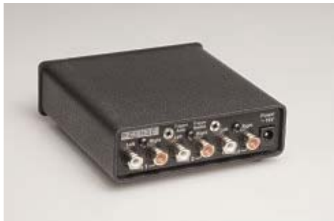
Επίχρυσα βύσματα και έξοδοι triggering για τον προενισχυτή.
