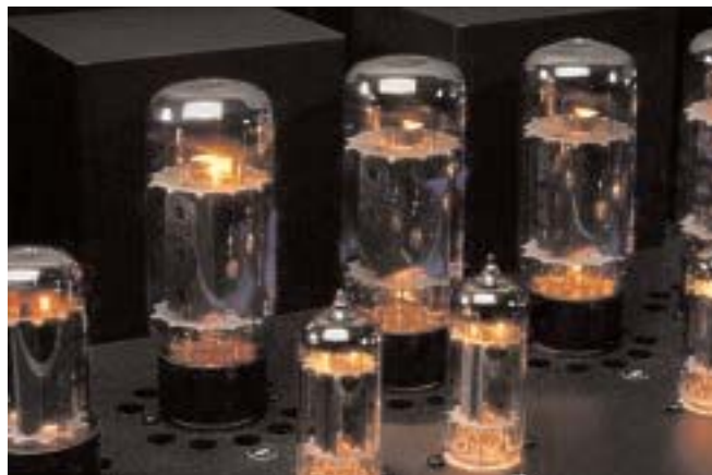
Ο BonaSus χρησιμοποιεί ανορθώτριες 5AR4, οδηγήτριες 12BH7 και τετροδούς 6CA7 για το στάδιο ισχύος, το οποίο είναι Ultralinear push-pull σε τάξη AB.
