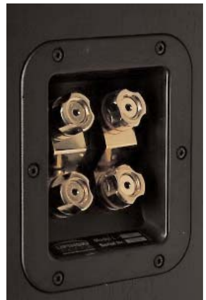
Το L-707 χρησιμοποιεί ακροδέκτες πολύ καλής ποιότητας και επιτρέπει την διπλοκαλωδίωση.
