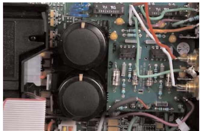
Το αναλογικό στάδιο είναι σχεδιασμένο γύρω από τους OPA604. Προσέξτε τους μεγάλους πυκνωτές του τροφοδοτικού καθώς και το ότι χρησιμοποιούνται συμβατικά υλικά και όχι SMD.
