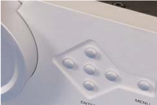
Η διάταξη των πλήκτρων σε σχήμα ρόμβου (με το “enter” στην μέση) έλκει την καταγωγή της από τις επαγγελματικές συσκευές και είναι πολύ εύχρηστη.
