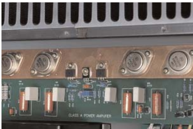
Τέσσερις διπολικοί αγωγοί πολωμένοι σε τάξη Α αποτελούν στο στάδιο εξόδου του ενισχυτή σε τοπολογία push-pull.
