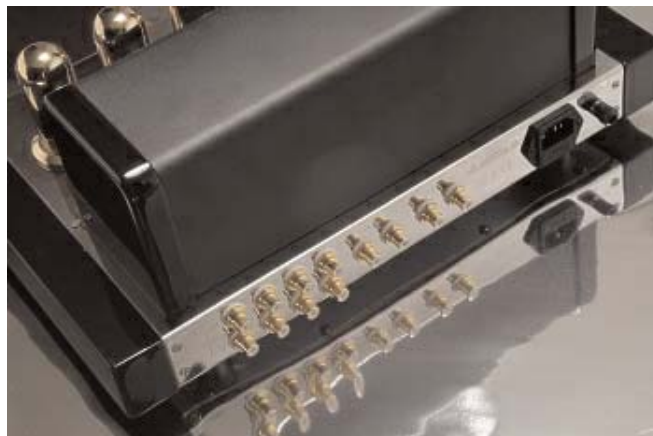
Τέσσερις είσοδοι, η μια rmono για κεφαλές mtr. Τα βύσματα είναι πολύ καλής ποιότητας. Ο προενισχυτής διαθέτει δύο ζεύγη εξόδων line.
