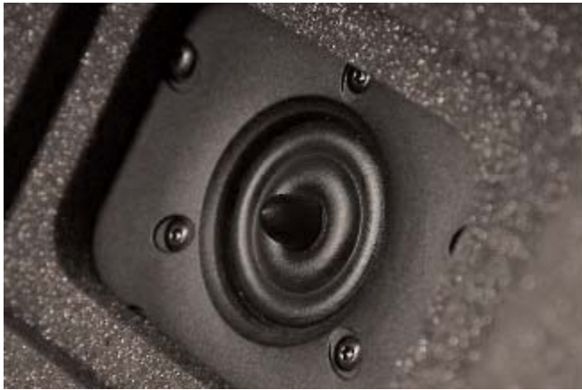
Το τούιτερ είναι ένα Ring Radiator της Vifa. Περιβάλλεται από αφρώδες υλικό ώστε να εξασφαλίζεται ελαχιστοποίηση των περιθλάσεων.
