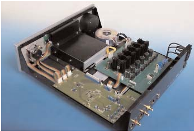
Η κατασκευή του 20.1 δεν είναι σύνθετη, είναι όμως φροντισμένη. Ο οδηγός του δίσκου είναι τοποθετημένος σε ελαστικά υλικά.
