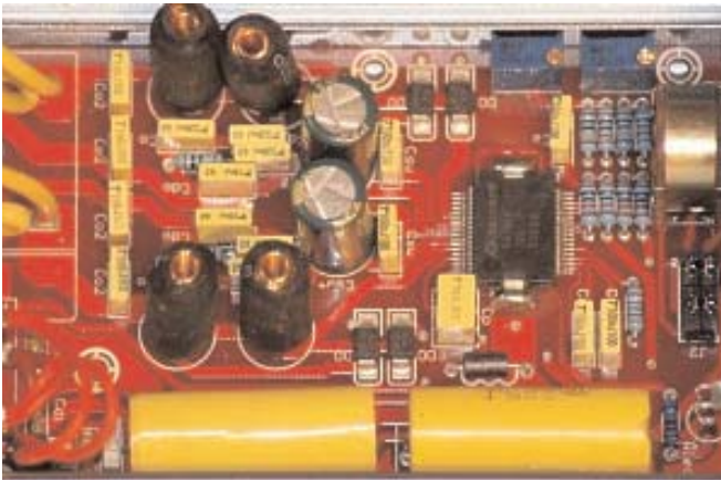
Ο ενισχυτής βασίζεται σε ένα ολοκληρωμένο TA2024 της Tripath το οποίο φαίνεται δεξιά. Αριστερά φαίνονται τα τέσσερα πηνία τα οποία είναι μικρά σε μέγεθος και χωρίς πυρήνα.
