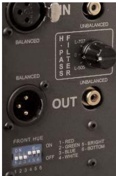
Ο ενισχυτής διαθέτει και εξόδους στις οποίες μπορεί να εφαρμοστεί και φίλτρο αποκοπής χαμηλών, για την περίπτωση που χρησιμοποιείται υπογούφερ.
