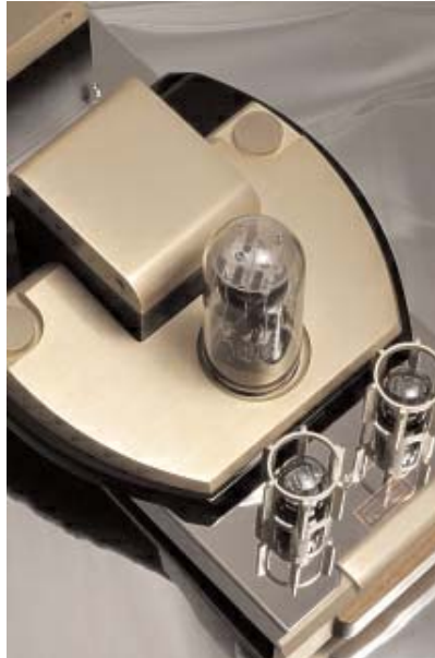
Το αντικείμενο του πόθου: Η τριόδος άμεσης θέρμανσης 845, ένα κλασικό εξάρτημα για σχεδιάσεις single ended που αντέχει θερμικές απώλειες μέχρι και 100W.
