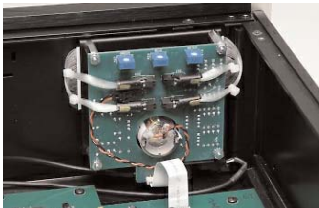
Προσέξτε τον τρόπο μεταφοράς του φωτισμού προς την επιφάνεια του οργάνου ένδειξης της στάθμης εξόδου: Δέσμες οπτικών ινών!
