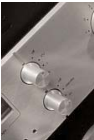
Η εκκίνηση του ενισχυτή γίνεται σε δύο στάδια, με το πρώτο να εφαρμόζει την τάση θέρμανσης των νημάτων και το δεύτερο τις υψηλές τάσεις.
