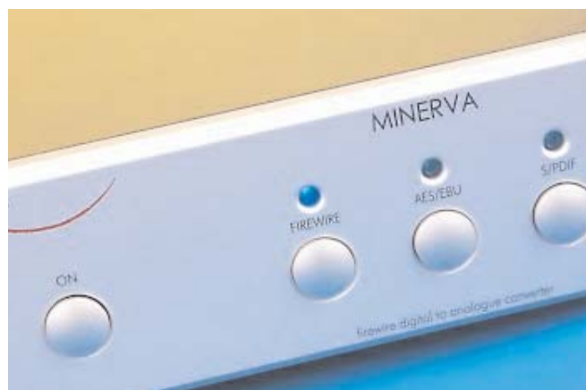
Τρεις πιστοποιημένοι διακόπτες επιτρέπουν την επιλογή των αντίστοιχων εισόδων. Η συσκευή "θυμάται" την τελευταία επιλογή του χρήστη.
