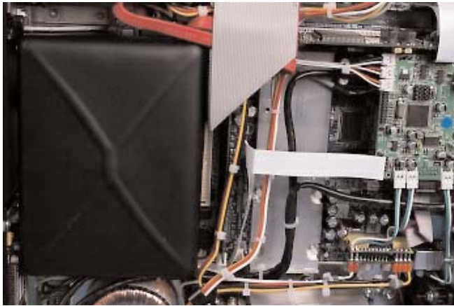
Το κεντρικό μέρος του σασί καταλαμβάνουν οι σκληροί δίσκοι (μέσα σε ελαστικό περιβλήμα, αριστερά) και ο υπολογιστής.
