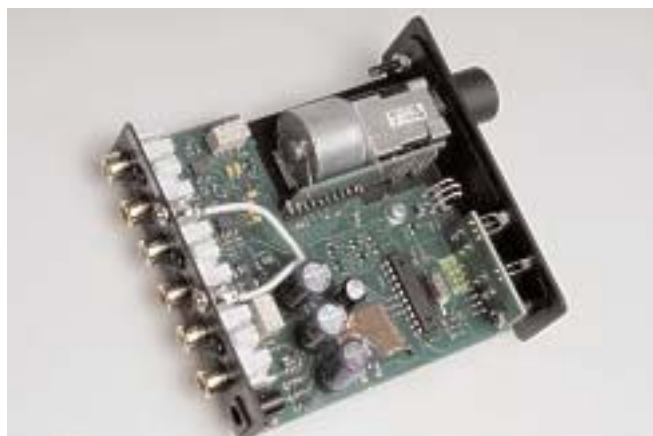
Το εσωτερικό του προενισχυτή κρύβει μια ποιοτική κατασκευή, βασισμένη σε τελεστικούς ενισχυτές χαμηλού θορύβου και έναν μικροελεγκτή της Atmel.
