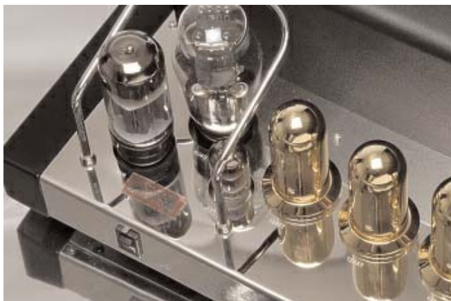
Η μεγάλη λυχνία, από την τριάδα που βρίσκεται στο αριστερό μέρος του προενισχυτή είναι η ανορθώτρια 5Z3P.
