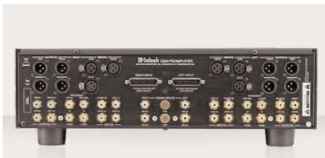
Το πίσω μέρος των δύο προενισχυτών είναι πανομοιότυπο. Εδώ θα βρείτε τα πάντα... Στο κέντρο είναι τοποθετημένα τα βύσματα τύπου “D” μέσω των οποίων γίνεται η επικοινωνία με τον C500C.
