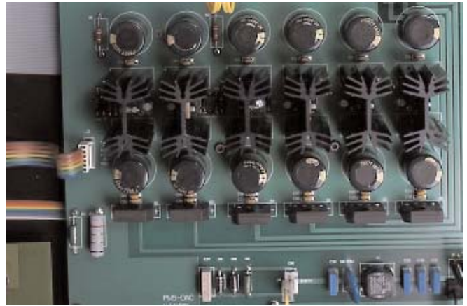
Το τροφοδοτικό αποτελείται από έξι διαφορετικά σταθεροποιημένα τμήματα, το κάθε ένα με δική του ανόρθωση. Στο κάτω μέρος της φωτο, στο κέντρο, βρίσκεται η γεφύρωση της γείωσης.
