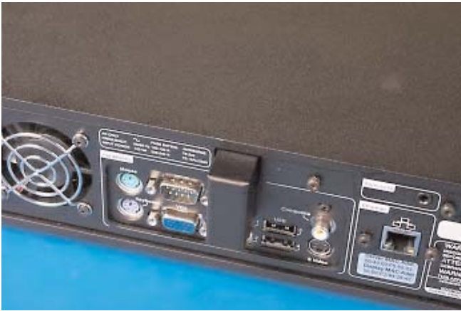
Ο χρήστης μπορεί να συνδέσει εξωτερική οθόνη, πληκτρολόγιο και ποντίκι για τον χειρισμό της συσκευής. Στις θύρες USB μπορούν να τοποθετηθούν σκληροί δίσκοι.
