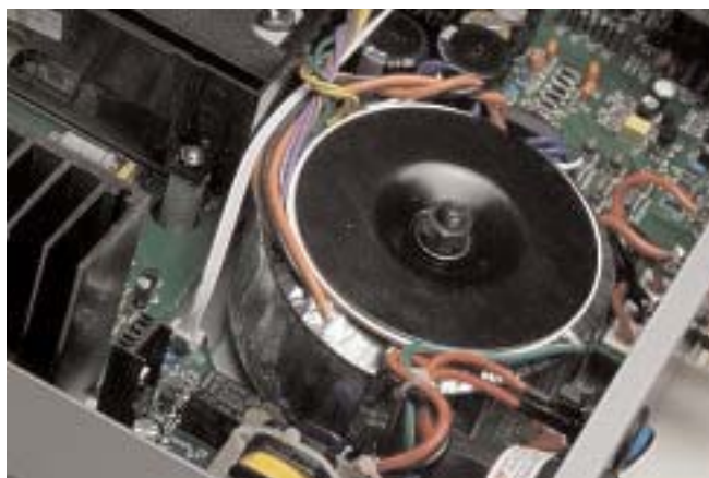
Η τροφοδοσία ξεκινά από αυτόν το μετασχηματιστή και βασίζεται σε δύο πυκνωτές των 8.200μF.
