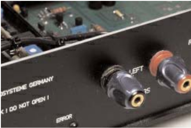
Ο τελικός ενισχυτής χρησιμοποιεί (στην συγκεκριμένη έκδοση) τα CablePod της Eichmann και προσφέρει ακόμη, μια έξοδο line για την σύνδεση και δεύτερου τελικού.
