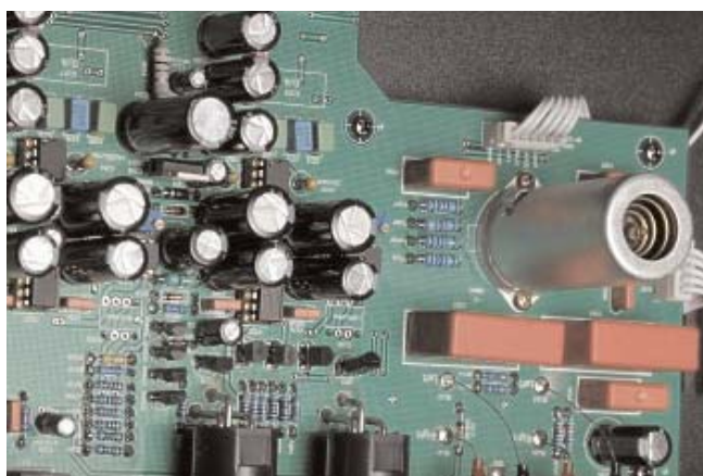
Η έξοδος του Muse 2.0 χρησιμοποιεί μια διπλοτρίοδο 6922 της Electro Harmonix. Στο κάτω μέρος φαίνεται το στάδιο με τους ημιαγωγούς.
