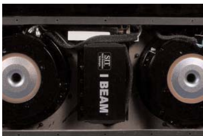
Το I Beam έχει σχεδιαστεί για εφαρμογές haptic audio. Εδώ χρησιμοποιείται με την αντίστροφη λογική. Έξυπνο και με βάση τις δυνατότητες του υπογούφερ, απαραίτητο.
