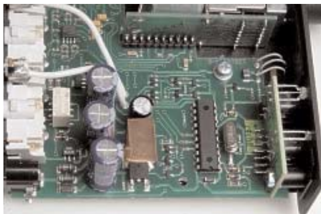
Ο μικροελεγκτής της Atmel, σε πρώτο πλάνο, ενώ επάνω αριστερά διακρίνεται ένας από τους τελεστικούς ενισχυτές χαμηλού θορύβου.
