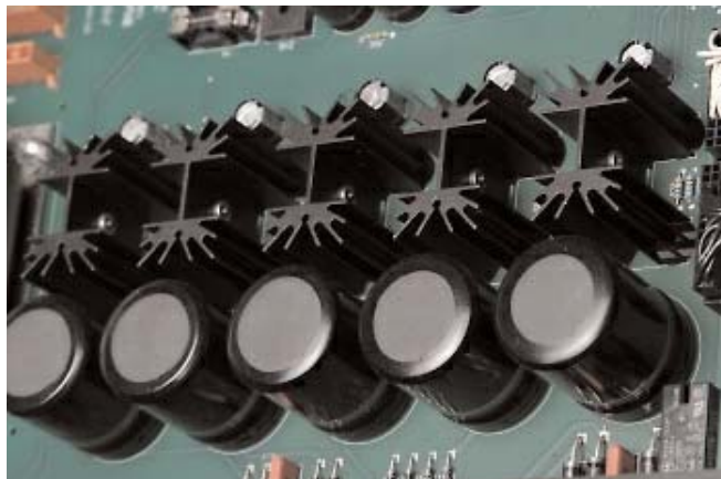
Πέντε τροφοδοτικά χαμηλής τάσης, το κάθε ένα με τον δικό του σταθεροποιητή και έναν πυκνωτή 9.000μF.
