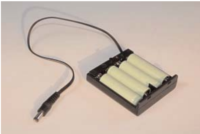
Οι τέσσερις συσσωρευτές του εξωτερικού τροφοδοτικού έχουν χωρητικότητα 2300mA. Η εμπειρία μας έδειξε ότι πρέπει να το χρησιμοποιήσετε, αν κυνηγάτε την μέγιστη απόδοση.
