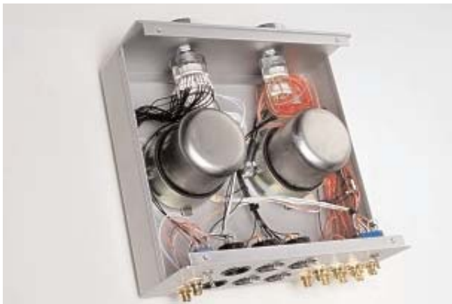
Το εσωτερικό της συσκευής καταλαμβάνεται ουσιαστικά από τους δύο μετασχηματιστές της S&B των οποίων η στήριξη είναι ελαστική, την άφθονη καλωδίωση από καλώδια αργύρου και τους δύο επιλογείς της ELMA.
