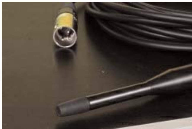
Αυτό είναι το μικρόφωνο που χρησιμοποιείται στις μετρήσεις. Η Lyngdorf προσφέρει και την βάση στήριξής του (η οποία δεν φαίνεται στην φωτο), γεγονός που κάνει τη ζωή του χρήστη πιο εύκολη.
