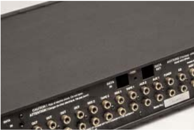
Ο προενισχυτής προσφέρει έναν μεγάλο αριθμό εισόδων line (4+2 βρόχους εγγραφής) καθώς επίσης και τέσσερις εξόδους προς τον τελικό ενισχυτή. Τα βύσματα είναι καλής ποιότητας.
