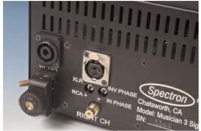
Ο χρήστης έχει στην διάθεσή του, εκτός της εξόδου σύνδεσης με τα ηχεία και μια είσοδο "Sense" η οποία επεκτείνει τον βρόχο ανάδρασης μέχρι την είσοδο των ηχείων. Είναι υλοποιημένη με Speakon.
