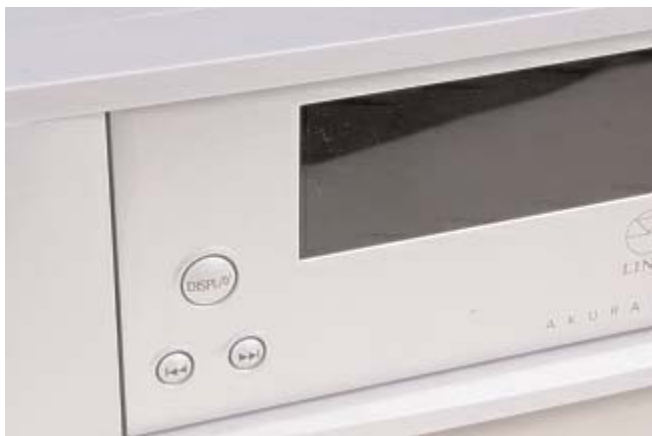
Στην πρόσοψη της συσκευής υπάρχουν πλήκτρα για τους στοιχειώδεις χειρισμούς. (play, stop, next, κ.λπ). Ο χρήστης μπορεί να επιλέξει το τί θα απεικονίζεται στην οθόνη. Στις πληροφορίες περιλαμβάνονται χρόνοι, στοιχεία του encoding και metadata.
