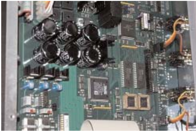
Το DSP που χρησιμοποιεί ο Medea για μέρος του upsampling, το reclocking και την αποέμφαση είναι ο ADSP 21065 της Analogue Devices
