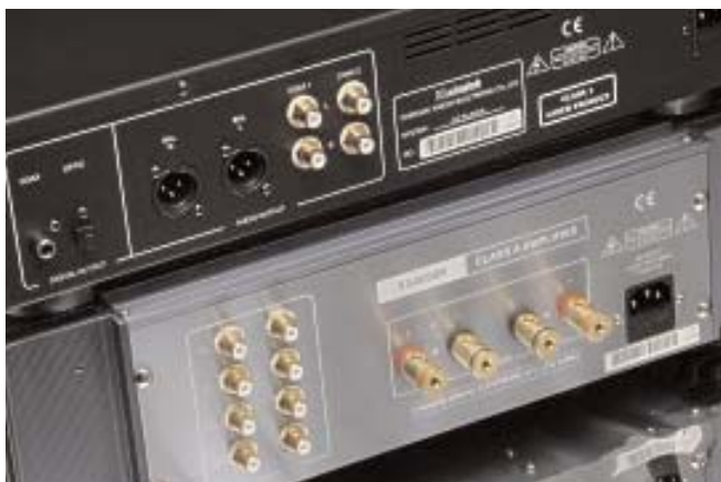
Το cd player περιλαμβάνει ένα πλήρες πακέτο εξόδων στο οποίο περιλαμβάνονται δύο single ended, μια balanced και δύο ψηφιακές. Ο ενισχυτής έχει τέσσερις εισόδους γραμμής και δύο εξόδους για την σύνδεση ηχείων. Δεν υπάρχει rec. out.
