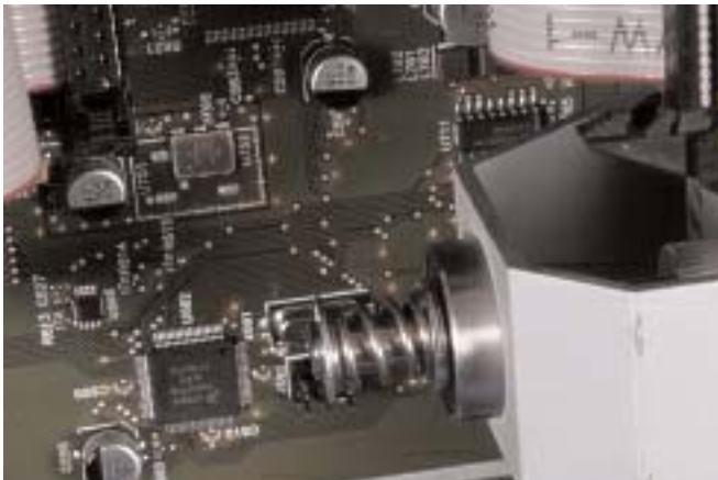
Το ρυθμιστικό της στάθμης χρησιμοποιεί οπτική κωδικοποίηση και είναι εξαιρετικό σε αίσθηση.
