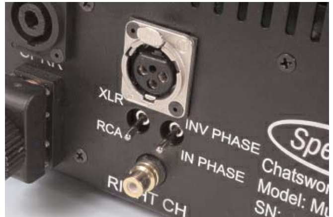
Ο ενισχυτής μπορεί να συνδεθεί μέσω single ended ή balanced εισόδου. Οι single ended εισοδοί είναι floating (δεν συνδέονται δηλαδή απευθείας με την γείωση της συσκευής) ώστε να επιτυγχάνονται χαμηλότερα επίπεδα θορύβου.
