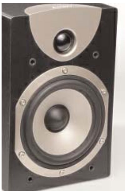
Τα ηχεία του συστήματος είναι δύο δρόμων, bass reflex και χρησιμοποιούν γούφερ με αρκετά μεγάλη διαδρομή, καθώς επίσης και τουίπερ θόλου.
