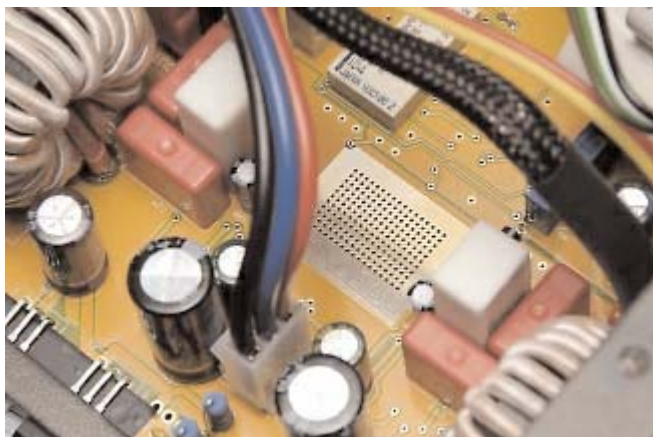
Η εταιρία δεν δίνει πληροφορίες για το είδος του διακοπτικού σταδίου το οποίο είναι "κρυμμένο" στην κάτω πλευρά του κυκλώματος. Εδώ φαίνονται τα πηνία της εξόδου και (κάτω αριστερά) δύο από τους τέσσερις ημιαγωγούς ισχύος.
