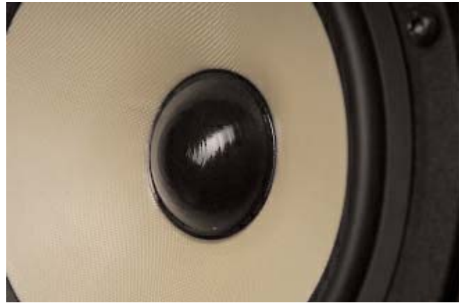
Τις χαμηλές και τις μεσαίες συχνότητες έχουν αναλάβει δύο 7ιντσα με κώνο από υαλονήματα, τα οποία, επιπροσθέτως είναι θωρακισμένα.
