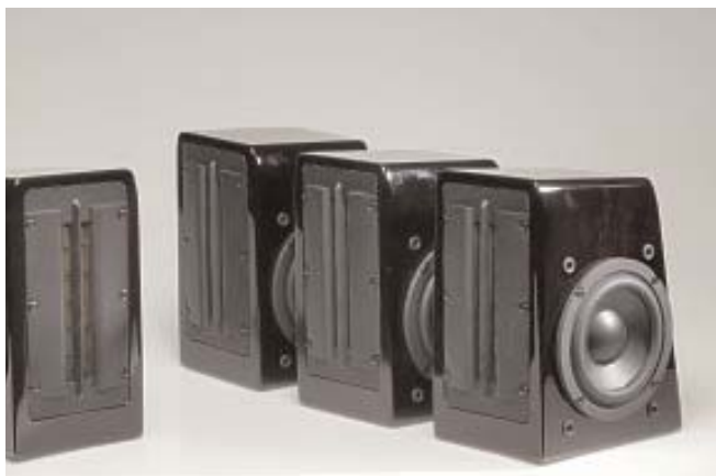
Τα CRM-2 χρησιμοποιούν ένα μεγάλο τούιτερ ribbon το οποίο καταλαμβάνει ολόκληρη την μπάφλα τους. Τα μιντ/γούφερ των δορυφόρων είναι τοποθετημένα πλευρικά ώστε να ακτινοβολούν προς τους τοίχους.
