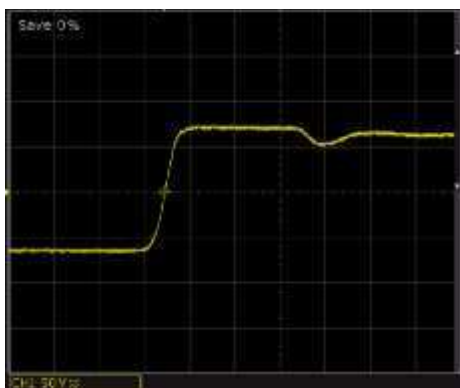
Απόκριση σε τετραγωνικό σήμα 1kHz. Μέγιστη ισχύς σε φορτίο 8Ω.
