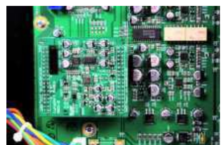
Η καρδιά του συστήματος: Δύο αρθρώματα της Lyngdorf. Το ένα από τα δύο (βρίσκεται σε δεύτερο επίπεδο και δεν διακρίνεται) περιλαμβάνει τον επεξεργαστή ADSP-BF561 της Analog Devices. Στο επάνω μέρος της φωτογραφίας και στο κέντρο, διακρίνεται ο μετατροπέας a/d της AKM.
