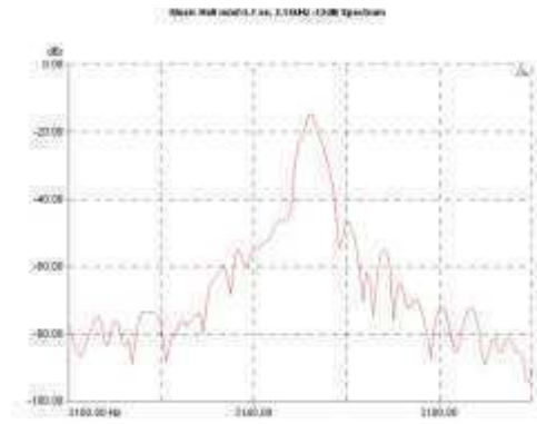
Φάσμα ενδοδιαμόρφωσης από προϊόντα W&F και Rumble. Σήμα αναφοράς: 3.15kHz/-12dB, εύρος: 3100-3200Hz
