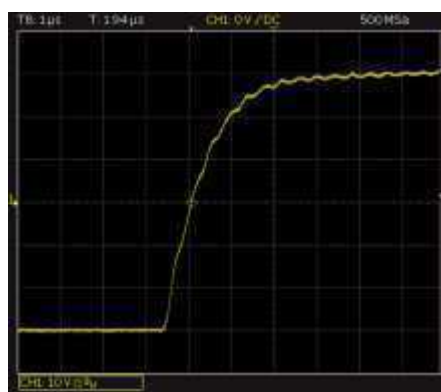
Τετραγωνικό σήμα 1kHz, μέγιστη ισχύς σε φορτίο 8Ω
