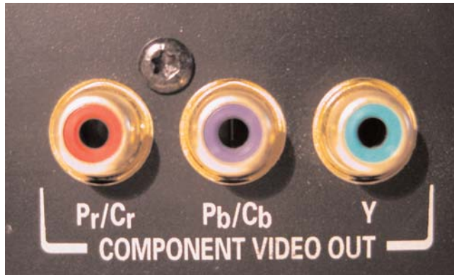
Η συνήθης γραμμή μεταφοράς σημάτων εικόνας είναι αυτή που χρησιμοποιεί τα σήματα χρωματοδιαφορών (Pb/Cb, Pr/Cr) και φωτεινότητας (Y). Τα βύσματα είναι τα γνωστά τύπου Cinch. Σημειώστε πάντως, ότι η σωστή ονομασία είναι YUV, επειδή ο συμβολισμός Y/Cb/Cr αφορά μόνο σε ψηφιακά σήματα.
