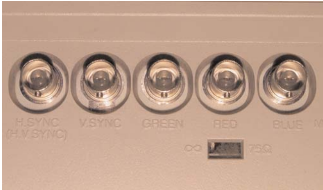
Η μεταφορά σήματος συνιστωσών R, G, B με ξεχωριστές γραμμές οριζόντιου και κατακόρυφου συντονισμού (H, V) απαιτεί πέντε βύσματα τα οποία είναι τύπου BNC.
