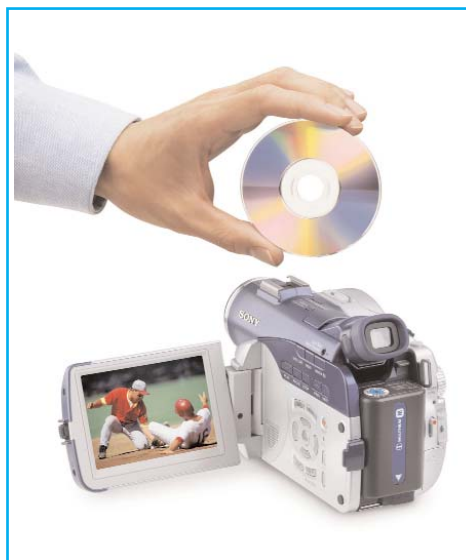
Τα νέα camcorder που χρησιμοποιούν δίσκους DVD διαμέτρου 8cm συνδυάζουν μικρό μέγεθος μηχανής και εγγραφή σε άφθαρτο μέσο.
